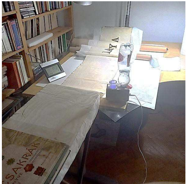
A szalag rugalmasítása ultrahangos párosítással, a gyűrődések, deformált felületek lesúlyozásával
